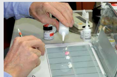
Abmischen der Keramikmassen auf der neuen Feuchthalteplatte von Creation (Aqualine Master).
